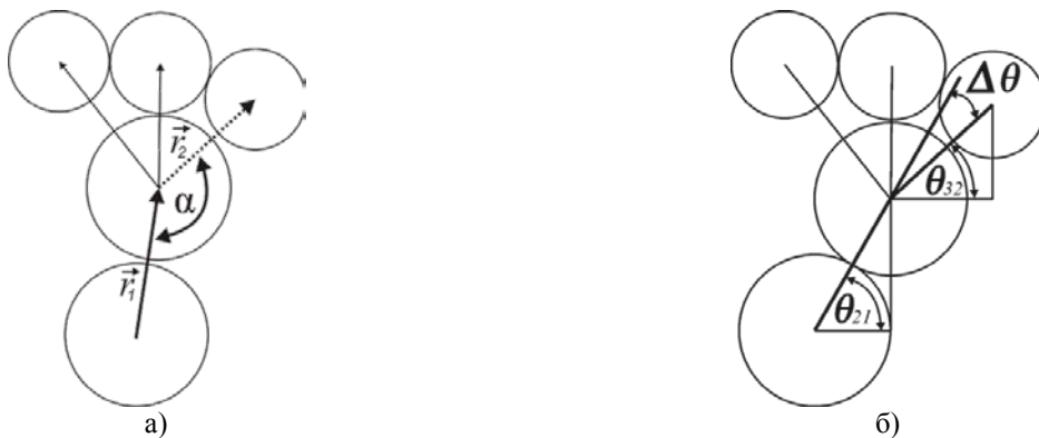
Слика 2.1.2.4. Идентификација наредне граничне честице а) упоређивањем углова б) упоређивањем одступања углова
